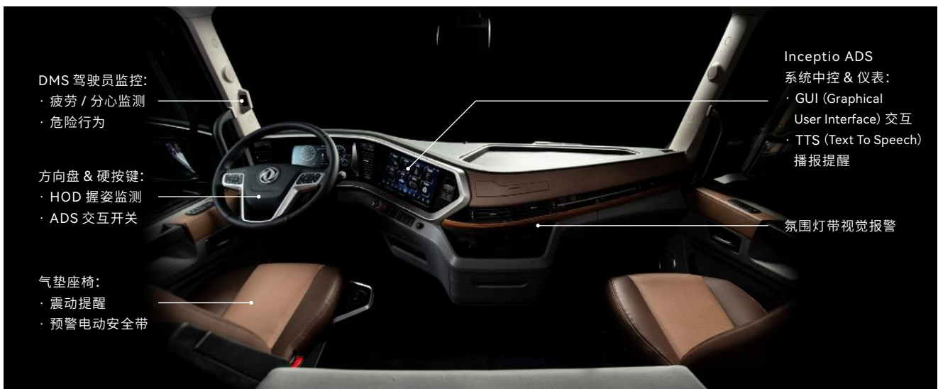
* 图：赢彻科技 - 多模态全冗余人机交互系统
